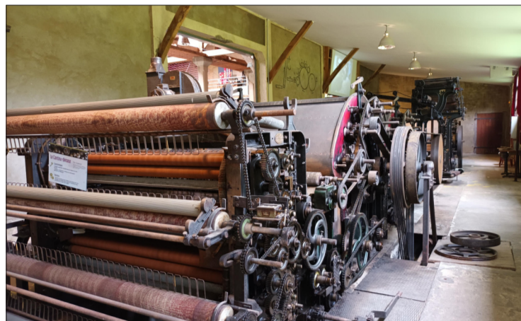
Le diviseur sépare la laine cardée en bandelettes appelées pré-fil.
