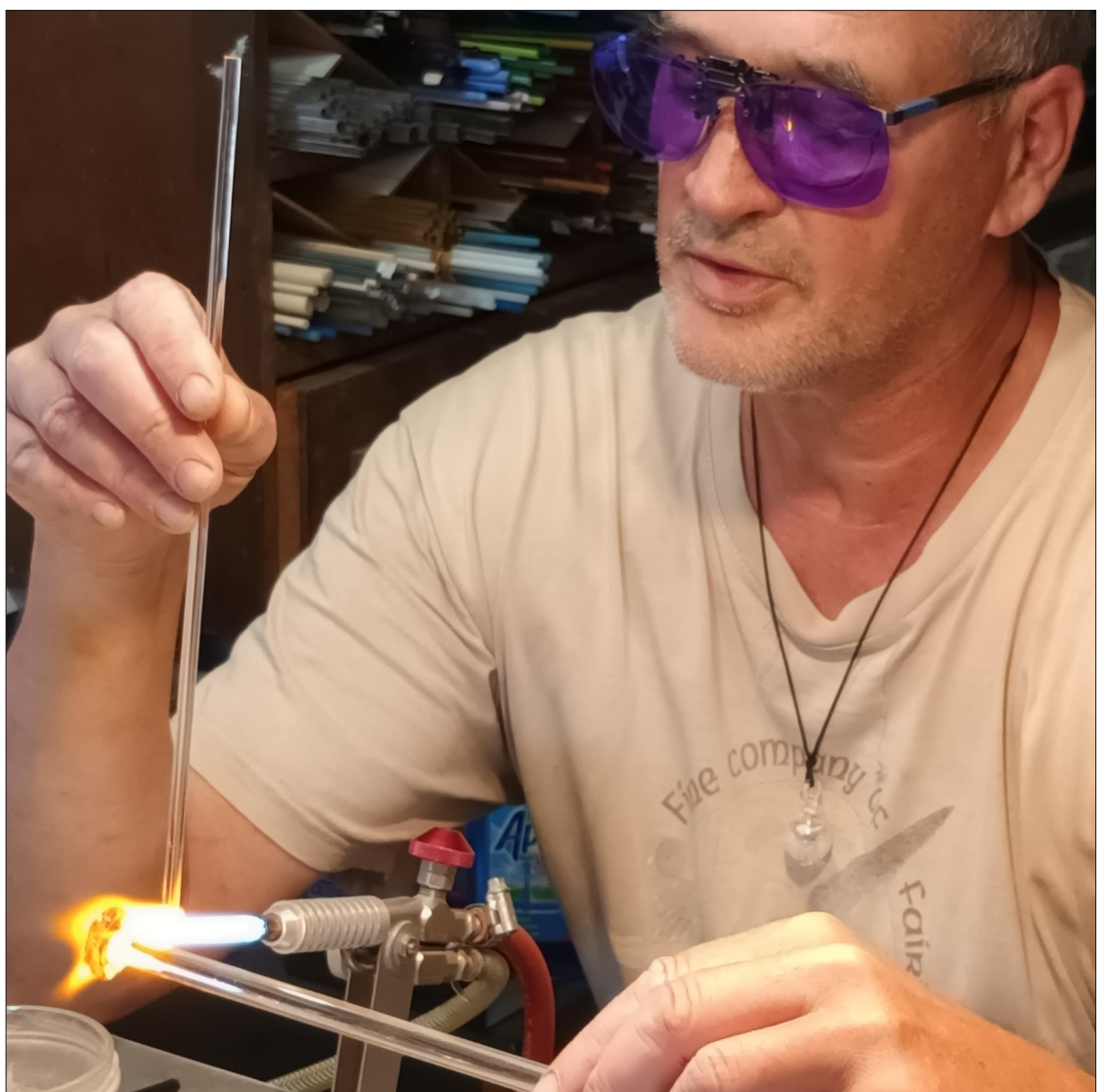
Les lunettes aux verres teintés permettent à Laurent de mieux voir les couleurs se former sous le chalumeau.
